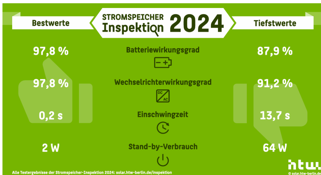
Abbildung 2 Labortestergebnisse der Stromspeicher-Inspektion 2024
