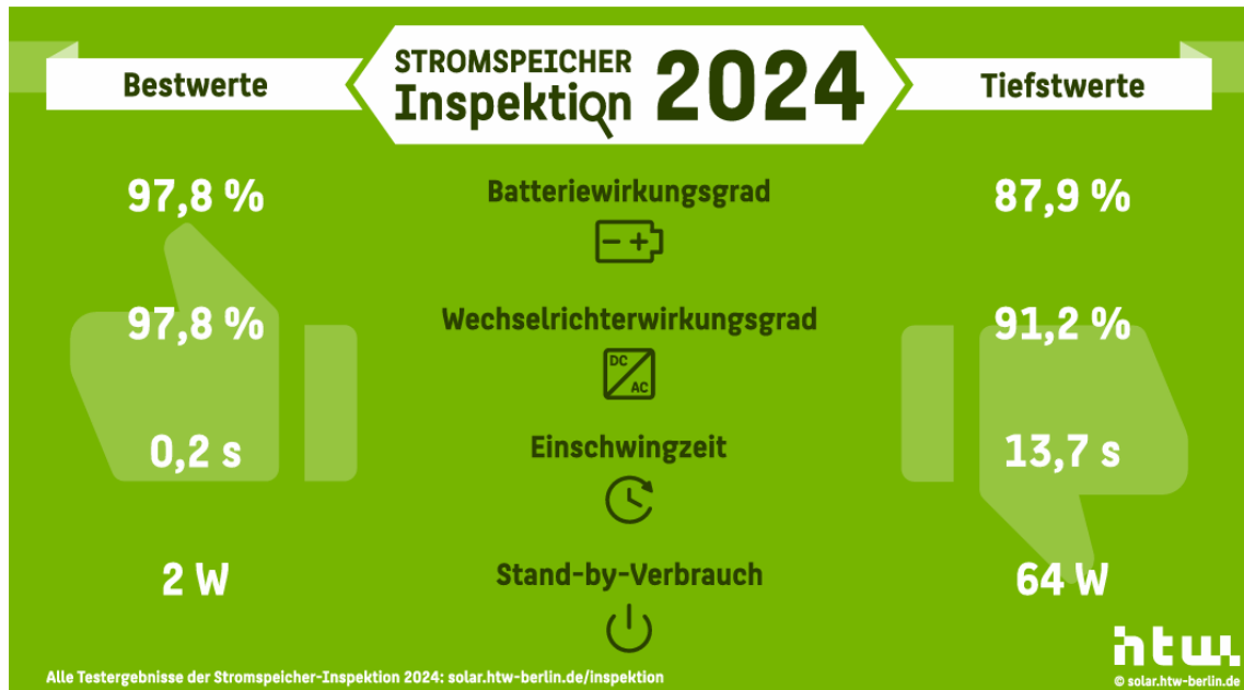
Abbildung 2 Labortestergebnisse der Stromspeicher-Inspektion 2024
